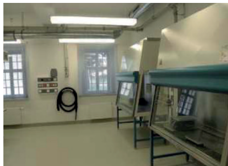
Pomieszczenia akcesji z komorami laminarnymi (do czyszczenia archiwaliów), ruchome stoły robocze oraz odkurzacz centralny. Centrum Konserwacji Archiwaliów i Zbiorów Bibliotecznych Archiwów Saksonii w Wärmsdorf (Archivzentrum Hubertusburg), Niemcy
